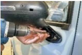
Abb. 10 • Befestigung und Abschluss der Spiegelmontage.
