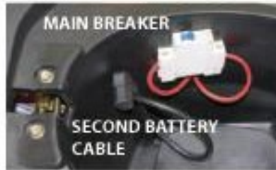
Abb. 7 · Hauptschalter im Bereich unter dem Sitz.
